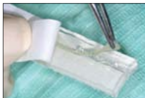
■Рис. 12. Извлечение стекловолокна из защитной муфты
