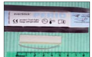
■Рис. 8. Стекловолокно в защитной силиконовой муфте
