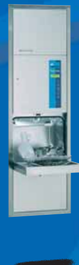
MEIKO TopLine 30 Моюще-дезинфицирующий автомат для монтажа в «стену» в комплекте с монтажной рамой. Модель для туалетов при операционных а также для палат пациентов. Размеры рамы: ширина 650 мм, глубина 450 мм, высота 2210 мм. Размеры видимой части: ширина 530 мм, высота 1760 мм.
