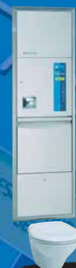
MEIKO TopLine 30 WC Моюще-дезинфицирующий автомат для монтажа в «стену» в комплекте с монтажной рамой. Модель для палат пациентов. Трубы и фиттинги подходят для подключения к любому типу унитазов. Размеры рамы: ширина 650 мм, глубина 450 мм, высота 2210 мм. Размеры видимой части: ширина 900 мм, высота 1760 мм.
