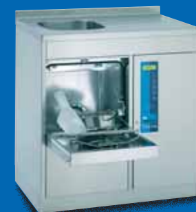
MEIKO TopLine 40 B Моюще-дезинфицирующий автомат кабинетного типа. Идеально подходит для установки под столешницу или единую рабочую поверхность. Помимо поверхности, которую можно использовать как рабочую, модель оборудована также мойкой для рук, размеры мойки 340 x 370 x 150мм. Размеры: ширина 900 мм, глубина 600 мм, высота 1000 мм.
